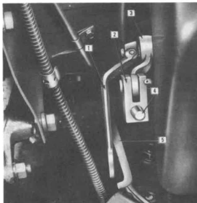
1. Throttle Lever 2. Shift Control Rod Clevis 3. Shift Control Rod Lever 4. Shift Control Rod 5. Throttle Rod
